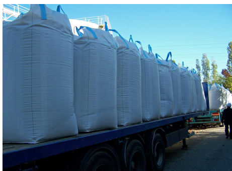
Chargement de Refiom en direction d'un CSDU classe 1
